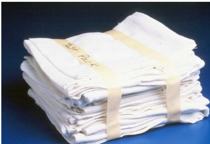
Exemplo de pacote teste manual utilizado como desafio à penetração do vapor.
