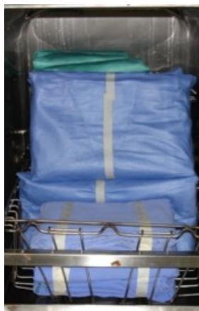
Exemplo de posicionamento de um pacote teste desafio no interior de uma autoclave.
